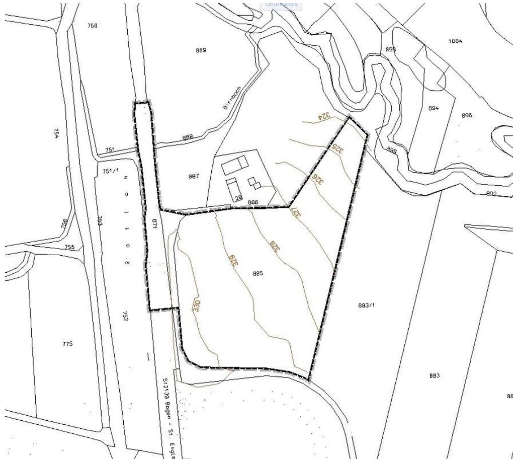
Das Gelände fällt von Südwesten nach Nordosten von ca. 330 m ü NHN auf 324 m ü NHN im Bereich des Rückhaltebeckens. Der bebaubare Bereich liegt im Bereich zwischen 330 m ü NHN und 327 m ü NHN.
